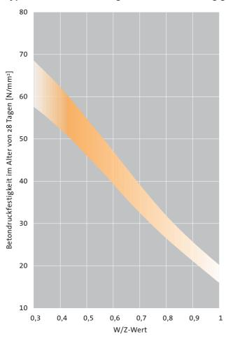
Das Bild zeigt den mit **Fluvio 5** in Abhängigkeit vom W/Z-Wert bei vollständiger Frischbetonverdichtung und einer Erhärtungstemperatur von 20°C erreichbaren Betonfestigkeitsbereich.
