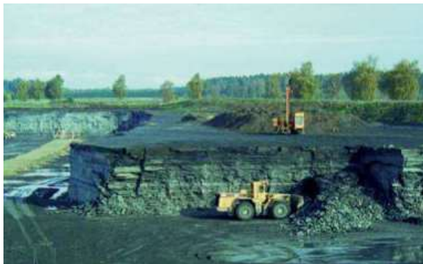
Abb. 1.1.11 Schieferabbau durch Sprengung
