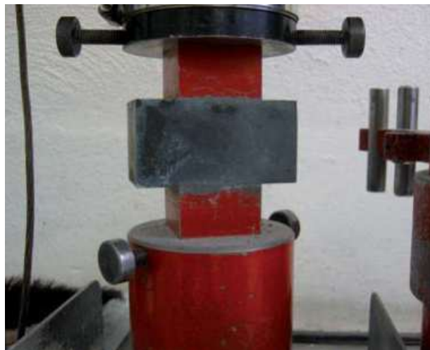
Abb. 1.1.21 Zementfestigkeiten am Mörtelprisma 40 x 40 x 160 mm
