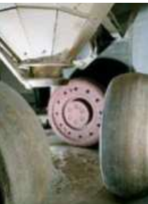
Abb. 1.1.3 Walzenschüsselmühle zum Feinmahlen des Rohgesteins
