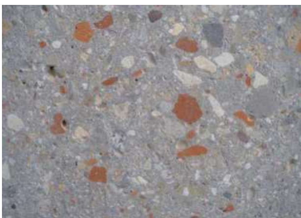
Abb. 1.4.3 Geschliffene R-Betonoberfläche mit RC-Körnung Typ 2
