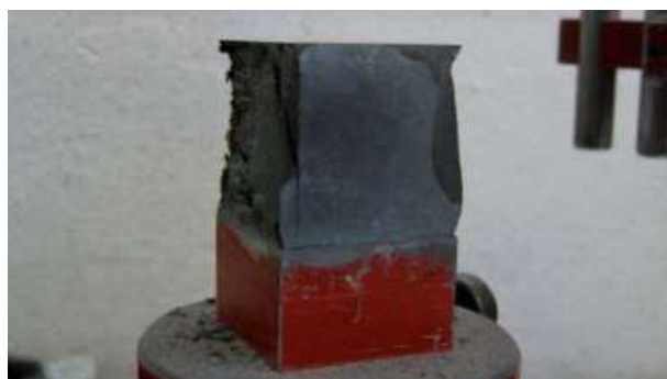
Abb. 7.13.1 Bruchbild sprödes Material - Druckfestigkeitsprüfung am Mörtelprisma
