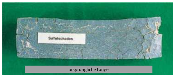
Abb. 10.6.1 Durch Sulfatangriff geschädigtes Zementmörtelprisma, Volumenvergrößerung (Treiben)
