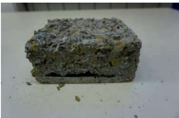
Abb. 3.2.6 (links) Prüfkörper nach 28 FTSW mit starken Abwitterun- gen
