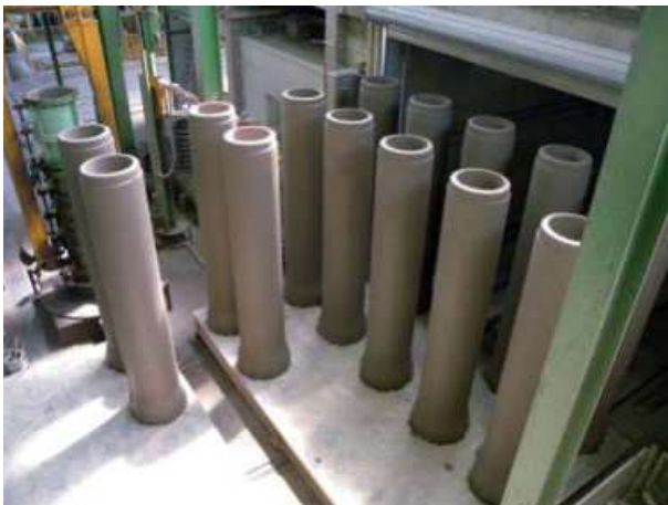
Abb. 9.2.2 Betonrohre direkt nach der Herstellung
