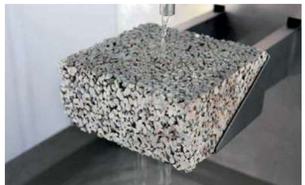
Abb. 7.11.4 Demonstration der Wasserdurchlässigkeit an einem Stein aus Dränbeton
