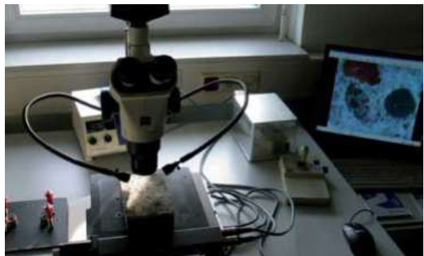
Abb. 7.2.5 Stereomikroskop mit automatischer Bildanalyse zur Ermittlung der Luftporenkennwerte am Festbeton
