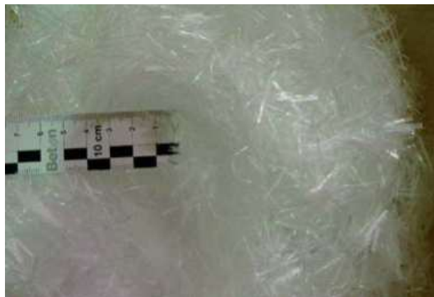
Abb. 8.16.12 Polypropylenfaser 20 mm Länge
