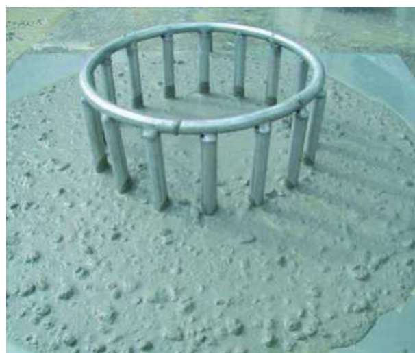
Abb. 3.8.8 (rechts) Setzmaß - Selbstverdichtender Beton, mit Blockkiering
