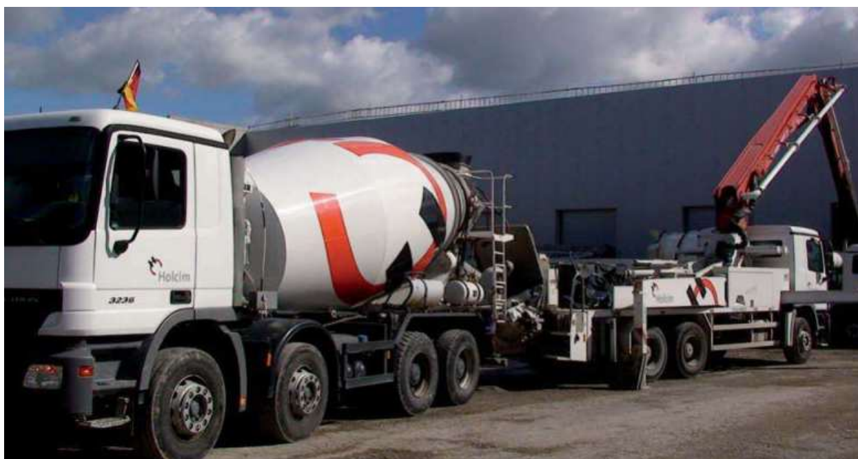
Abb. 4.2.1 Fahrmischer und Betonpumpe
