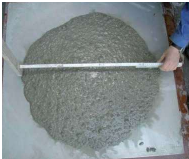
Abb. 7.4.4 Ausbreitmaß Leichtverdichtbarer Beton F6
