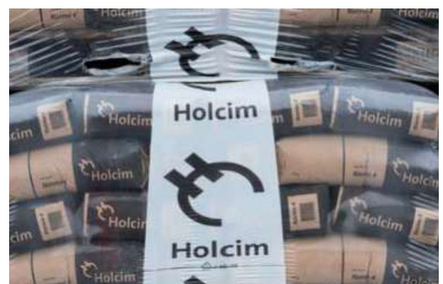
Abb. 1.1.33-2 Schrumpffolie zum Schutz von Sackzement vor Feuchtigkeit
