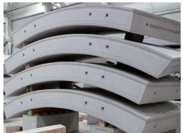
Abb. 10.6.2 Tübbinge - Bauteile, die oft in sulfathaltiger Umgebung eingebaut werden
