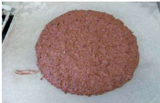
Abb. 7.7.4 Ausbreitmaß von Schwerbeton mit Hämatit
