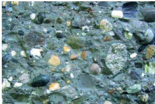
Abb. 7.9.3 (links) Bruchbild von Normalbeton. Beim Normalbeton (links) bricht zuerst der Zementstein.
