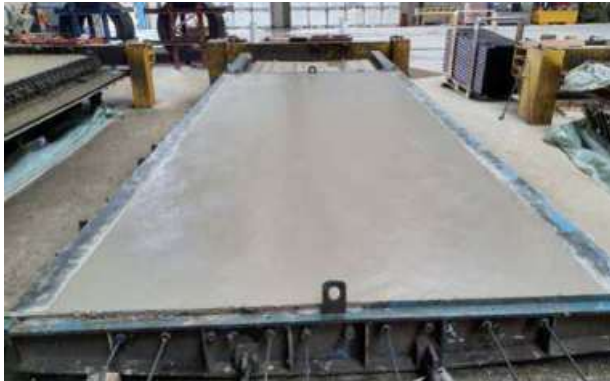
Abb. 7.16.2 Element hergestellt aus Geopolymerbeton
