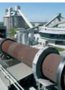
Abb. 1.1.4 Drehrohrofen, das Herzstück eines Zementwerks
