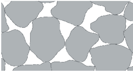
Abb. 3.1.7 Schlechte Raumverfüllung, hohe Porosität bei Beton mit nur einer Korngruppe (schematische Darstellung)
