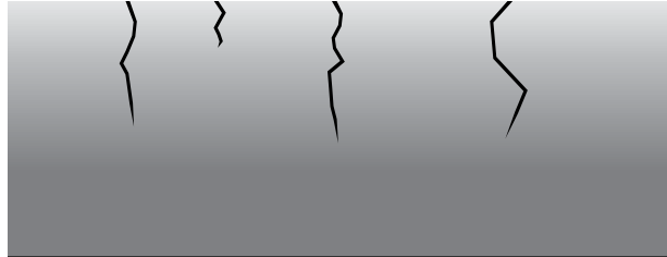
Abb. 10.3.8 Oberflächliche Risse als Folge des plastischen Schwindens
