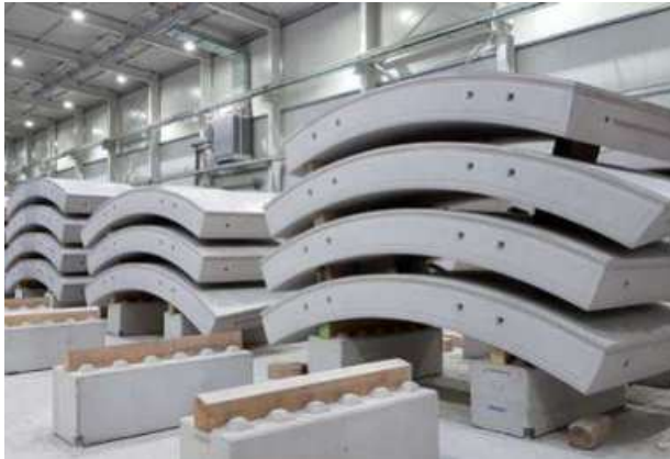
Abb. 8.7.3 Tübbinge nach der Herstellung in der Feldfabrik
