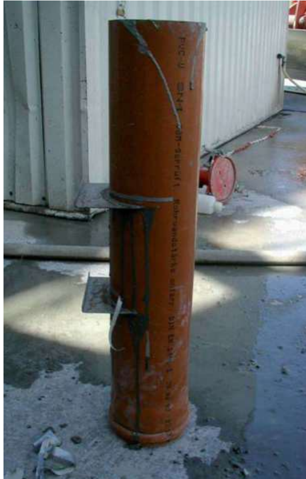
Abb. 10.1.5 Dreigeteiltes Rohr um die Entmischungsneigung zu prüfen
