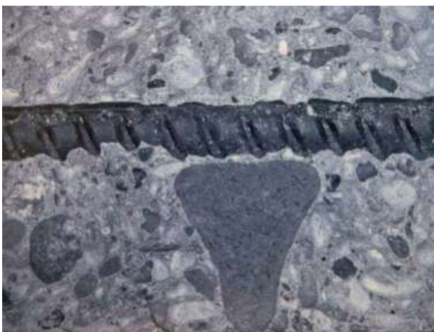
Abb. 3.4.2 Abstandhalter sorgt für ausreichende Betondeckung
