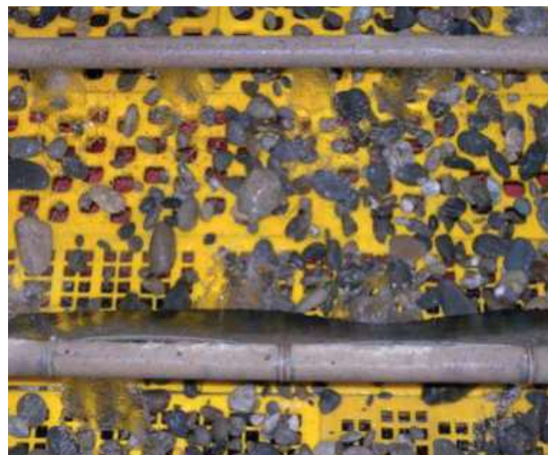
Abb. 1.3.16 Aussieben und Waschen von Gesteinskörnern in einem Kieswerk
