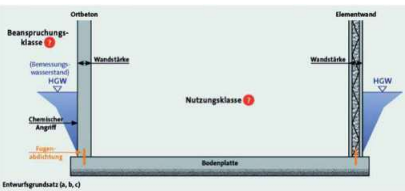
Abb. 7.1.1 Beanspruchungs- und Nutzungsklassen bei WU-Betonen
