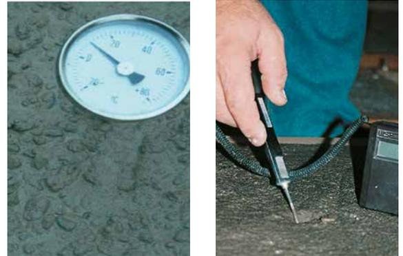
Abb. 3.7.2 Messen der Frisch- (links) und Festbetontemperatur (rechts)
