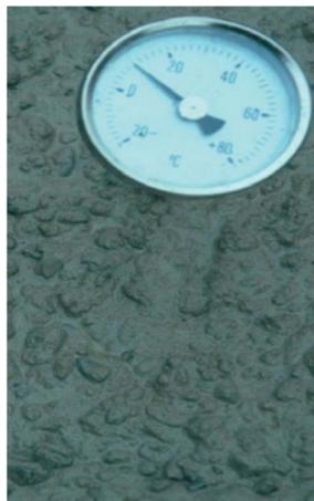
$$T_b = 0,7 \times 8 + 0,2 \times 10 + 0,1 \times 50 = 12,6 \text{ °C} = \text{Betontemperatur}$$
