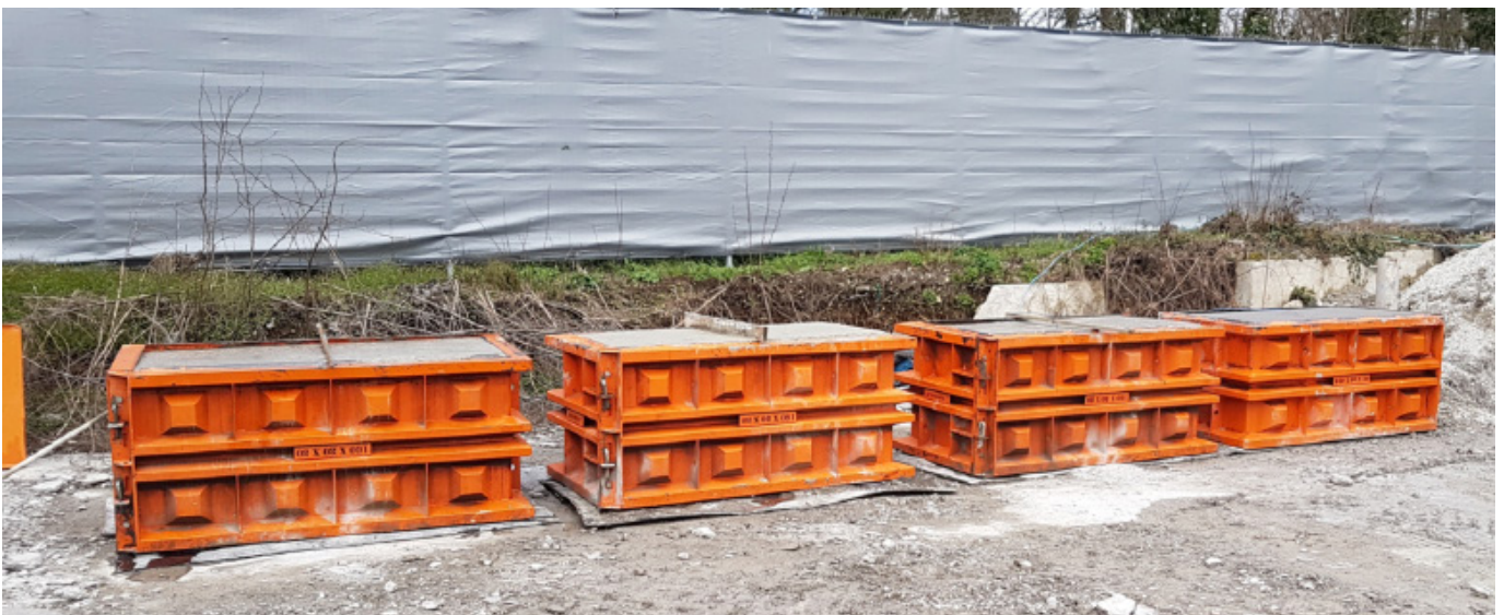
Messung der Hydratationswärme im Beton, am Systemblock 1,60 m x 0,80 m x 0,80 m
