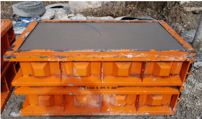
Messung der Hydratationswärme im Beton, am Systemblock 1,60 m x 0,80 m x 0,80 m
