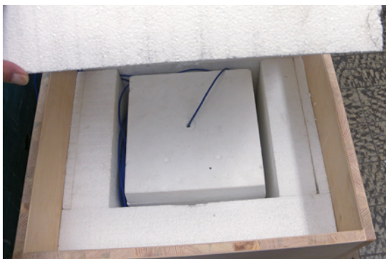
Bild 4: Styroporwürfel in Isolierbox
