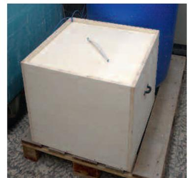
Abb. 3.1 Durchführung der Temperaturmessungen an gut gedämmten Probewürfeln
