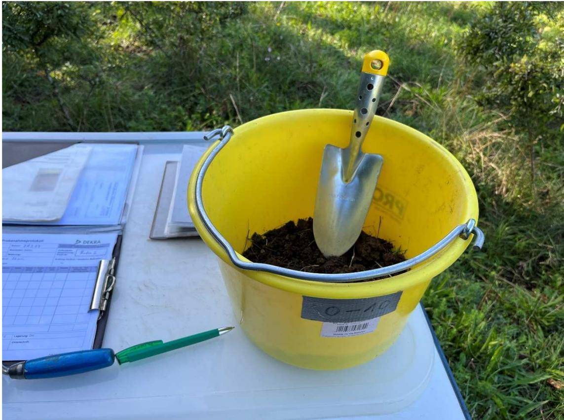
Foto 1: Bodenprobenahme Mischprobe aus 20 Einstichen
