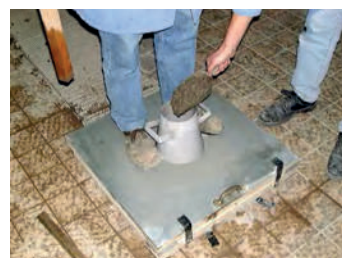
Trichter zur Hälfte mit Beton befüllen
