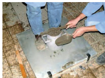
Beton oben eben abziehen (Kelle oder Stößel)
